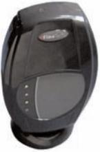
Un **récepteur statique**, placé au domicile de la personne, complète la surveillance mobile et prend éventuellement le relais du récepteur portable qui peut alors être soit mis en veille, ce qui permet d'en économiser la batterie, soit branché afin d'être rechargé. D'installation très simple, le récepteur statique communique les messages au support GPS.
